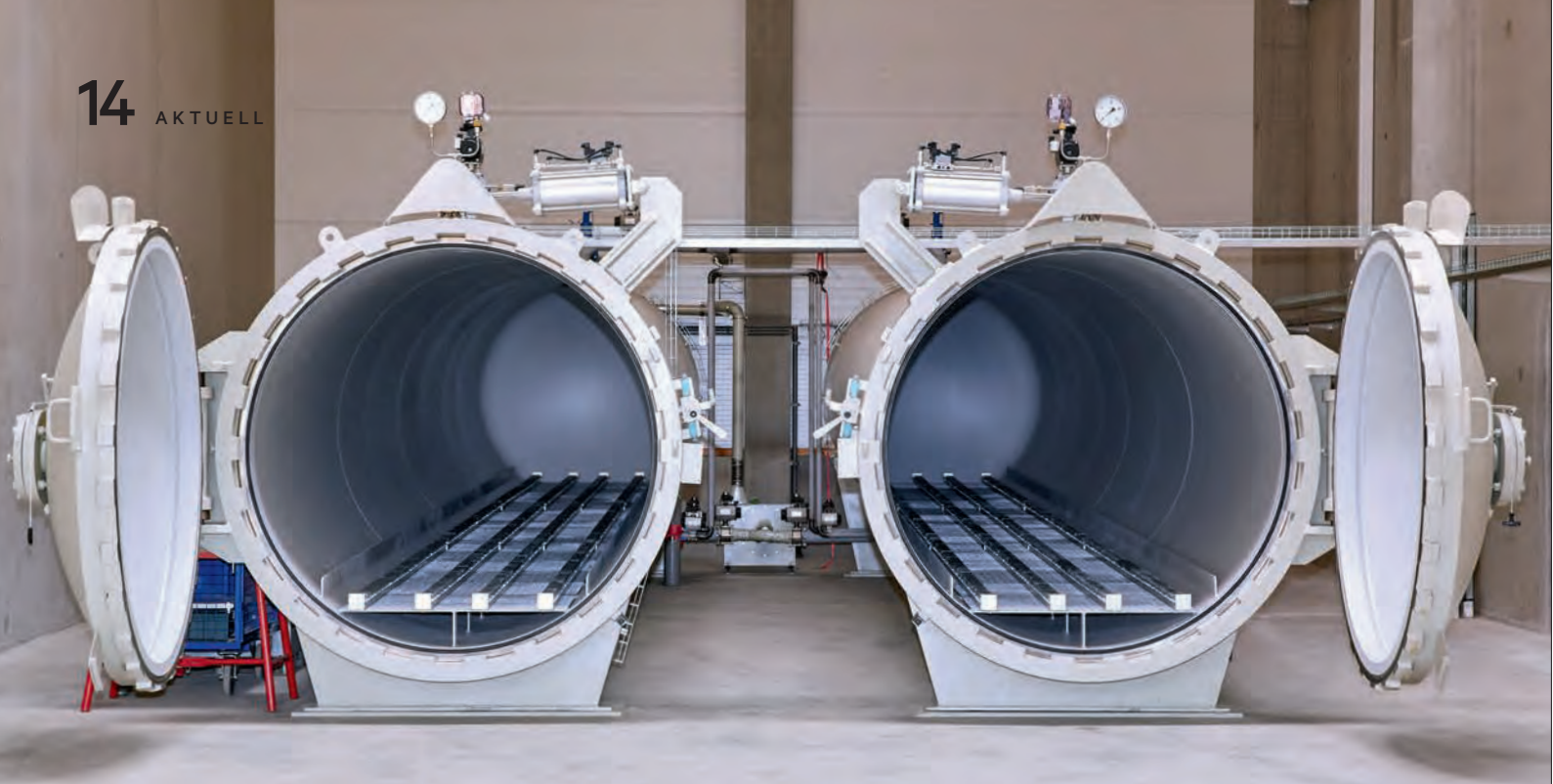
Die 2019 eröffnete Anlage besteht aus zwei Kammern, in denen über ein Schienensystem jeweils bis zu 13 Holzpaletten oder Container platziert werden können.
