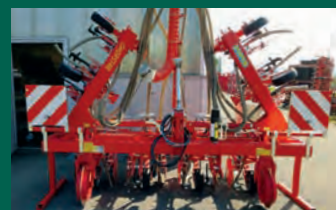
8330 Feldbach 0664/1234515 Einböck Chop Star Hackgerät mit Gänsefußscharen, Grundrahmen: hydraulisch klappbar, Pflanzenschutzbleche 17.900,-**
