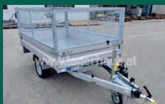
3910 Zwettl 002822/506-279 Humbaur Huk 152314 Rückwärtskipper mit montierten Stahl- gitteraufsatz 600 mm hoch, Gesamt- maße 3650 x 1540 x 1550 mm 4.899,-*
