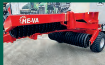
2100 Korneuburg 0664/8124254 Heva Tiproller 820 BJ 26, Arbeitsbreite 8,20 m, Ringdurchmesser 560 mm mit 9 Speichen, 2 x DW erforderlich 21.930,-*
