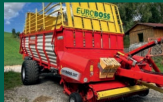
8605 Kapfenberg 0664/4049733 Pöttinger Euroboss 330 T BJ 15, Easy Move Messerbalken mit 31 Messer, hydr. Knickdeichsel 35.000,-**
