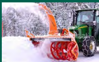
6262 Schlitters 0664/2820799 Kalthbacher KFS 850_270 Bj. 2024, Querneigungseinrichtung Auswurf- kamin mit hydr. 4-fach-Blende zusätzlicher Steuerkreis, Scherschrauben 36.900,-*
